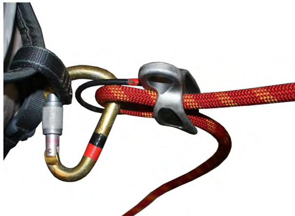
Fig 3 – cuidado: evitar que o mosquetão seja solicitado em seu eixo transversal (menor)
